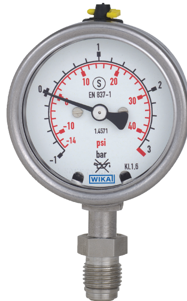
Манометр с трубкой Бурдона, модель 232.35.63, VCR®-совместимое технологическое присоединение с воздухоотводным винтом
