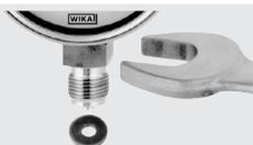
Pour les filetages parallèles, utiliser des joints d'étanchéité plats, des bagues d'étanchéité de type lentille ou des joints à écrasement WIKA sur la face d'étanchéité ①. Pour des filetages coniques (par exemple des filetages NPT), l'étanchéité doit se faire sur les filetages ② en utilisant un matériau d'étanchéité approprié (EN 837-2).
