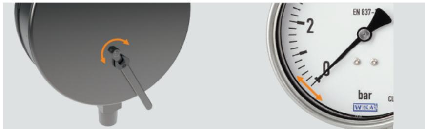
Если стрелка отклоняется от нулевой точки (без подачи давления), регулировку точки нуля можно выполнить путем поворота шестигранной гайки, расположенной сзади прибора. Для регулировки шестигранной гайки нужен гаечный ключ 7 мм. Диапазон регулировки составляет  $\pm 25^\circ$ .
