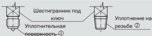
Момент затяжки зависит от используемого уплотнения. Для облегчения ориентации рекомендуется выполнять присоединение манометра с помощью LH-RH соединения или накидной гайки. Если манометр оснащен устройством сброса давления, его необходимо защитить от блокировки твердыми отложениями и грязью.
