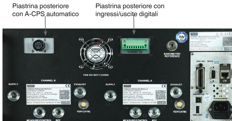
Figure 8.9 - Pannello posteriore con piastrina posteriore con A-CPS e piastrina posteriore con ingressi/uscite digitali
