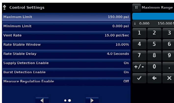
Figure 6.4.3.7 - Impostazione del limite di controllo
