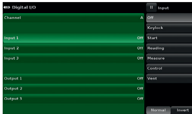
Figure 6.4.11 B - Assegnazione ingresso digitale
