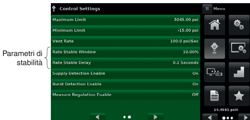
Figure 6.4.3.9 Parametri di stabilità del rateo della pressione
