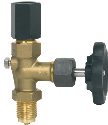
Absperrventil nach DIN 16270, Spannmuffe/Zapfen G 1/2, PN 250
