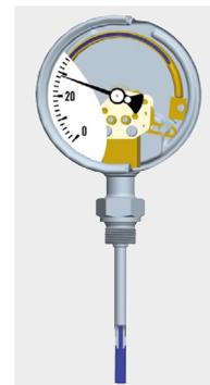
Изменения температуры окружающей среды не влияют на результат измерения, так как для их компенсации между стрелочным механизмом и трубкой Бурдона встроены биметаллический элемент.
