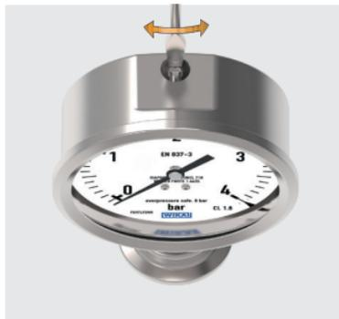
Подстройка нуля может выполняться с помощью плоской отвертки после удаления заглушки сверху корпуса. Отклонения показаний индикатора в результате естественных колебаний атмосферного давления и перепада высот (до 2000 м над уровнем моря) могут компенсироваться подстройкой нулевой точки.
