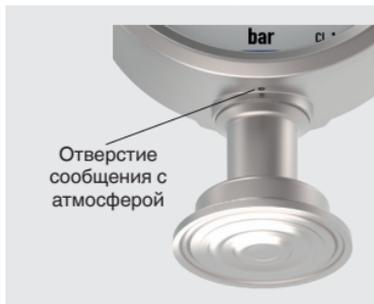
Во избежание изменения давления внутри корпуса измерительный прибор оснащен специальным отверстием внизу корпуса. В случае образования конденсата внутри корпуса или попадания жидкости извне данное отверстие может использоваться для дренажа.
